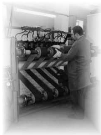
Rezanie z výrobnéj šírky na štandardné rozmery
